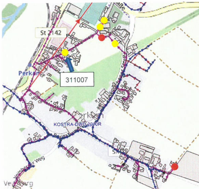
Abbildung 16: Überstauerscheinungen in Perkam nach Sanierungsvorschlag Q_m = 25 \text{ l/s}
